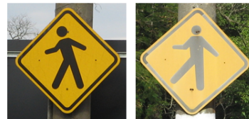
Figura 1. Imagem de placa degradada.
