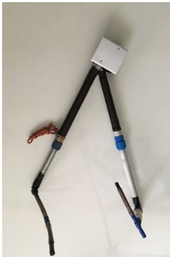
Figura 1. Rumicam, dispositivo para captura de vídeos de ruminantes. Fonte: INOVISAO (2018).
