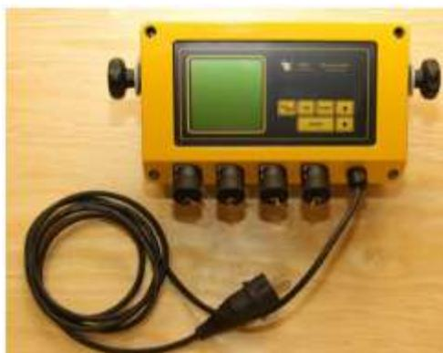
**Figura 3:** Unidade de Controle do equipamento VAKI Bioscanner Fish Counter.
