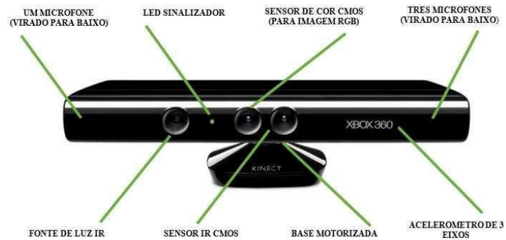
Figura 7: Sensor de movimento Kinect e suas partes constituintes
