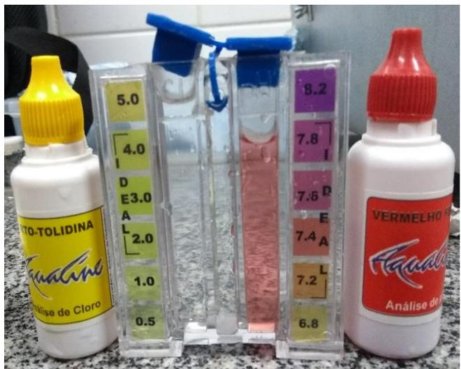
Figura 4.3: Escala de leitura do cloro e ph.
