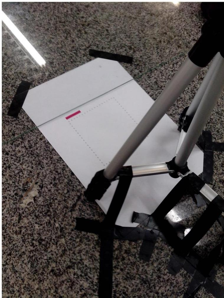
Figura 16: Moldura de fundo para posicionamento da folha de soja.
