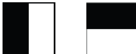
Figura 24: Filtros em x (esquerda) e filtros em y (direita)
