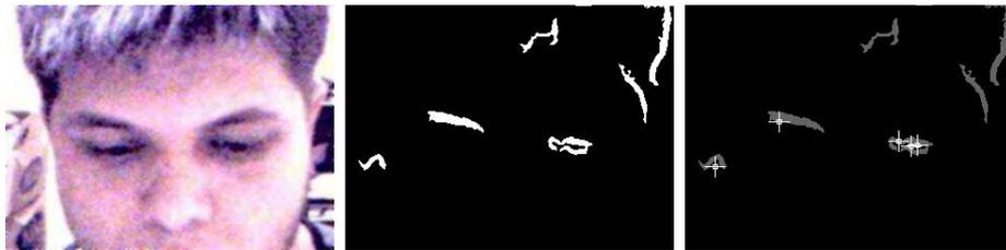
Figura 7.2: Processo de caso de acerto parcial. Imagem original, à esquerda, após eliminação de ruídos, ao centro, e após localizador dos olhos, à direita
