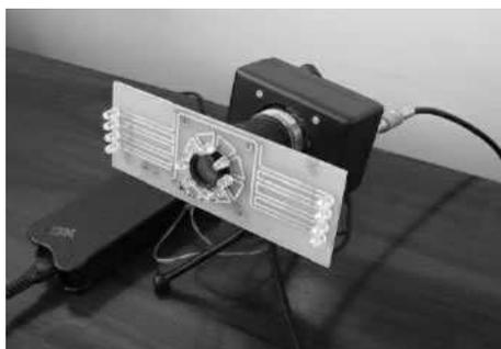
Figura 2.3: Sistema hardware que auxilia na detecção do olhar
