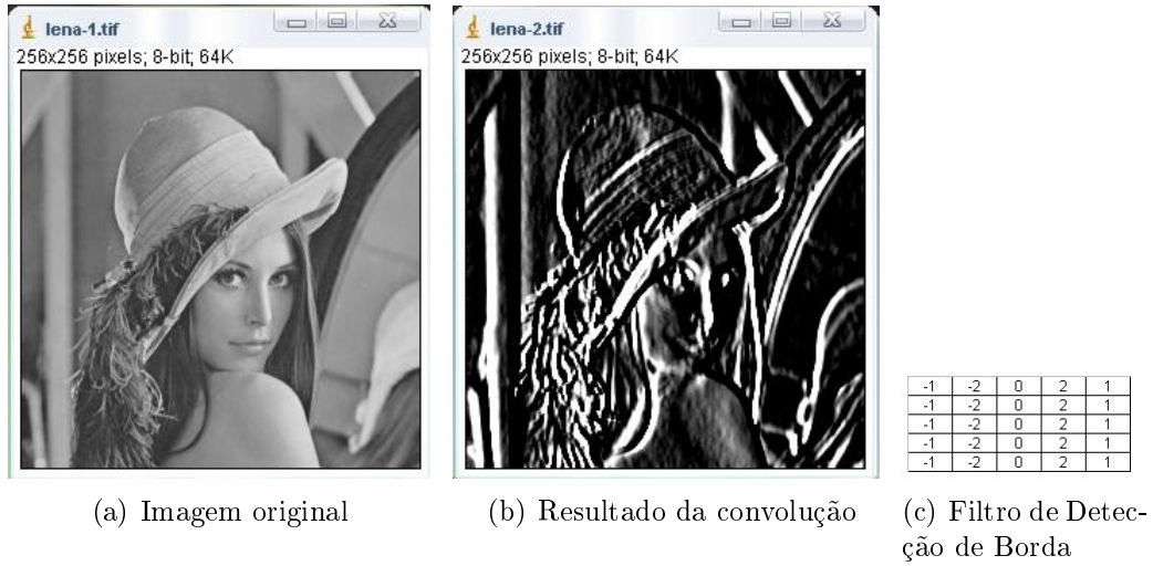
Figura 3.2: Exemplo do resultado da aplicação de um filtro de detecção de borda Figura 3.2(c) em uma imagem.
