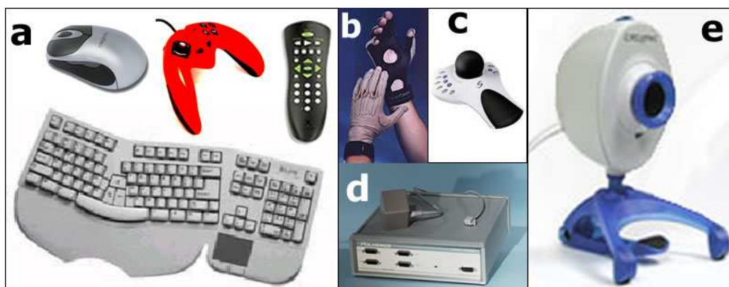
Figura 2.2: Dispositivos de interação homem-máquina. a) Dispositivos comuns: teclado, mouse, joystick e controle remoto. b) Dispositivo com sensor eletro-mecânico: CyberGlove. c) Dispositivos de interação 3D: SpaceBall. d) Dispositivo magnético: Fastrack. e) Dispositivo de captura de imagem: WebCam
