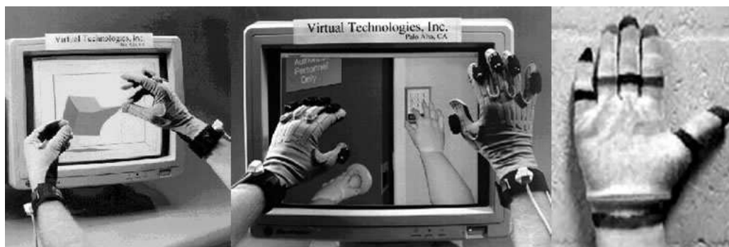
Figura 2.5: Soluções invasivas: luvas com sensores eletromecânicos (capturam os movimentos das mãos diretamente) e luvas marcadas (facilitam o rastreamento das mãos).
