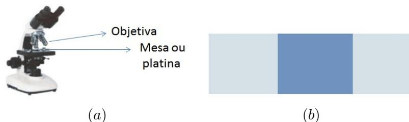
Figura 4.5: (a) Imagem de um microscópio evidenciando a mesa e a objetiva (b) Imagem ilustrativa da placa de vidro (representada pela cor azul clara) e lamela (representada pela cor azul escura).
