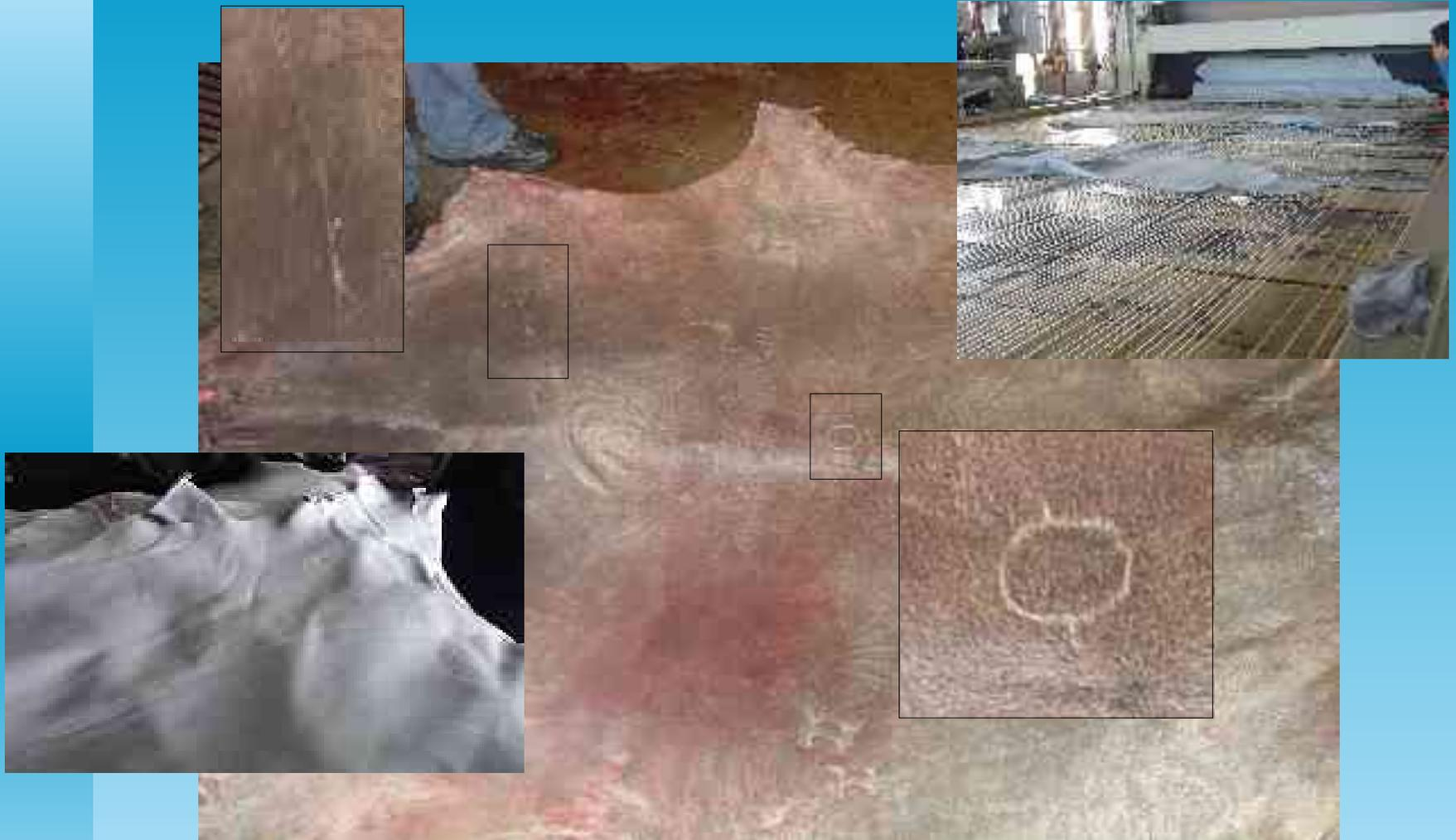
**Detecção Automática de Defeitos em Couro Bovino utilizando Visão Computacional, Aprendizagem Automática e Tecnologia Adaptativa**
