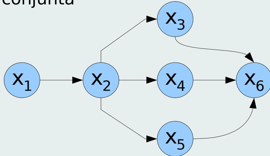
$$p(x_1, x_2, x_3, x_4, x_5, x_6) = p(x_1) \cdot p(x_2 | x_1) \cdot p(x_3 | x_2) \cdot p(x_4 | x_2) \cdot p(x_5 | x_2) \cdot p(x_6 | x_3, x_4, x_5)$$
