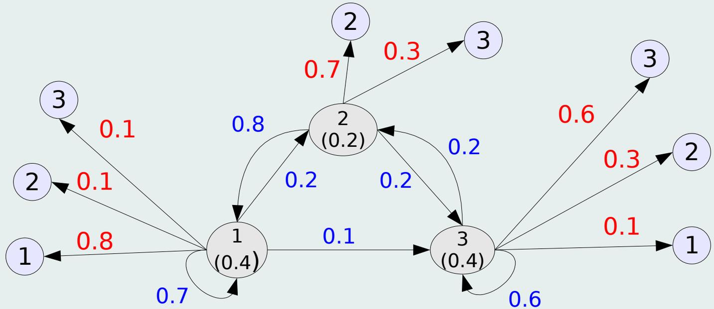
$$\pi = \begin{bmatrix} 0.4 \\ 0.2 \\ 0.4 \end{bmatrix} \quad A = \begin{bmatrix} 0.7 & 0.2 & 0.1 \\ 0.8 & 0 & 0.2 \\ 0 & 0.4 & 0.6 \end{bmatrix} \quad B = \begin{bmatrix} 0.8 & 0.1 & 0.1 \\ 0 & 0.7 & 0.3 \\ 0.1 & 0.3 & 0.6 \end{bmatrix}$$
