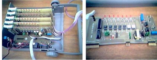
**Figura 4.** placa para estimulação de cada coluna de eletrodos, e montagem das 5 placas
