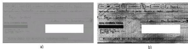
Figura 2.6: Imagem original (a) e imagem após equalização de histograma (b). Fonte:[9]
