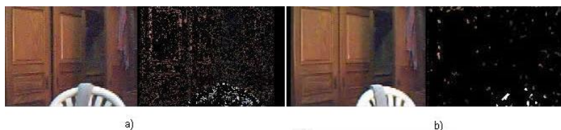
Figura 3.15: Segmentação verificando a vizinhança do pixel
